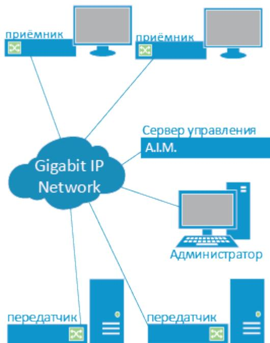
Если при прямом подключении максимальное расстояние передачи сигнала зависит от среды передачи (коаксиальный кабель - до 500 м, витая пара - до 140 м, или оптоволокно - до 10 км), то при коммутации через IP-сеть никаких ограничений по расстоянию нет.
